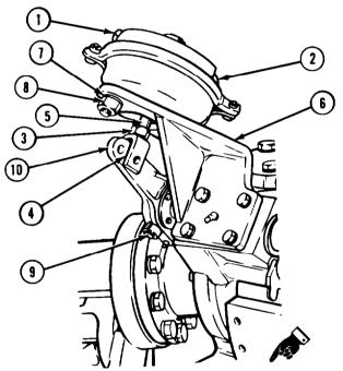
MODEL A BRAKE CHAMBER MOUNTING
