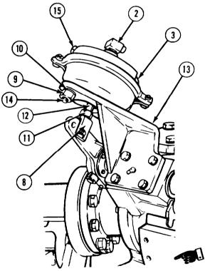
MODEL A BRAKE CHAMBER MOUNTING
