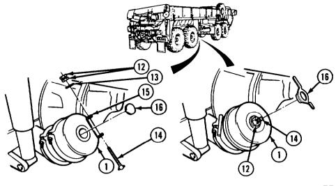
MODEL A BRAKE CHAMBER MODEL B BRAKE CHAMBER
