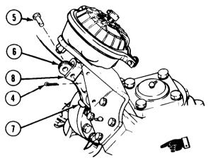
MODEL A BRAKE CHAMBER MOUNTING
